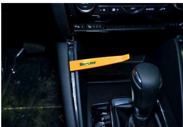
Фото 1.9. Снять левую накладку центрального тоннеля возле ручки АКПП
