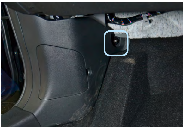
Фото 1.3. Клипса крепления накладки левой кик-панели
