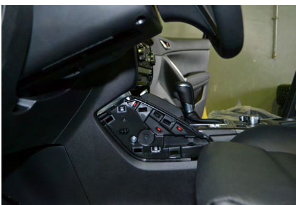
Фото 1.10. Левая накладка центрального тоннеля возле ручки АКПП снята
