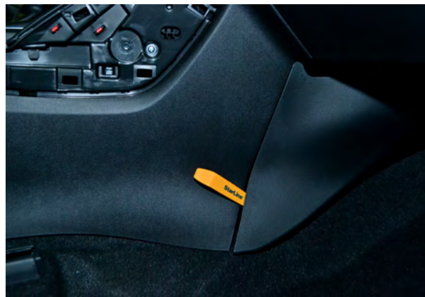
Фото 1.14. Снять нижнюю правую накладку центрального тоннеля
