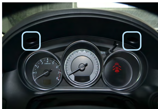
Фото 2.2. Клипсы крепления накладки панели приборов
