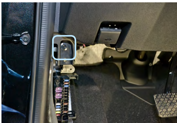
Фото 1.4. Болт крепления накладки под рулевой колонкой
