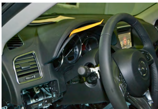
Фото 2.3. Снять декоративную накладку панели приборов
