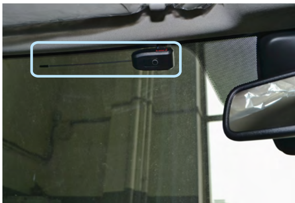
Фото 3.1. Возможное место установки антенного модуля
