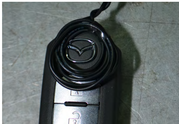
Фото 11.2. Расположение антенны на ключе
