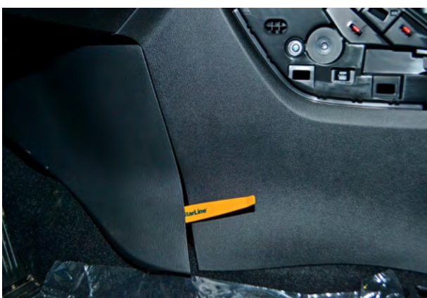
Фото 1.13. Снять нижнюю левую накладку центрального тоннеля
