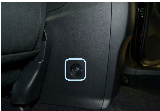
Фото 1.7. Левый саморез крепления центрального тоннеля
