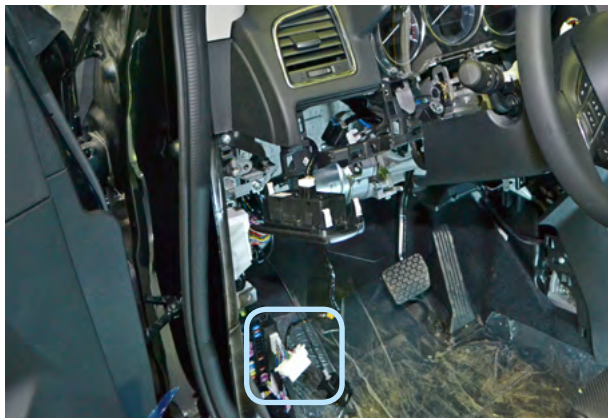
Фото 7.1. Местоположение диагностического разъёма
