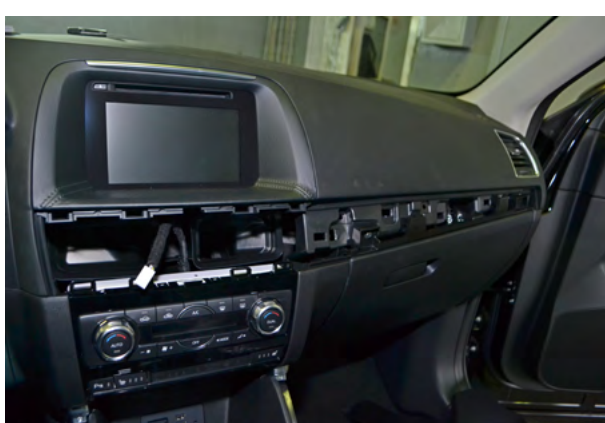
Фото 1.16. Декоративная накладка передней панели снята
