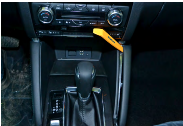
Фото 1.11. Снять правую накладку центрального тоннеля возле ручки АКПП
