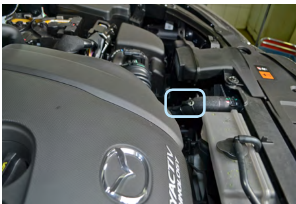
Фото 4.3. Место установки датчика температуры двигателя
