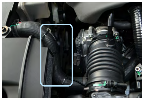
Фото 4.4. Крепление датчика температуры двигателя
