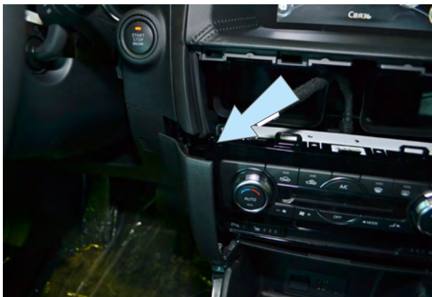
Фото 1.17. Центральный тоннель смещён на три сантиметра назад
