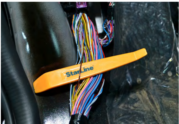
Фото 9. Провод концевика двери водителя (коричнево-чёрный)
