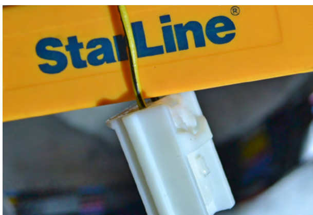
Фото 10.5. Имитация нажатия педали сцепления (жёлто-чёрный)
