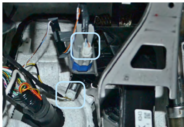
Фото 10.4. Местоположение разъёмов концевиков педали сцепления
