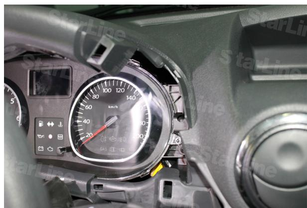
Фото 2.8. Декоративная накладка справа от щитка приборов снята
