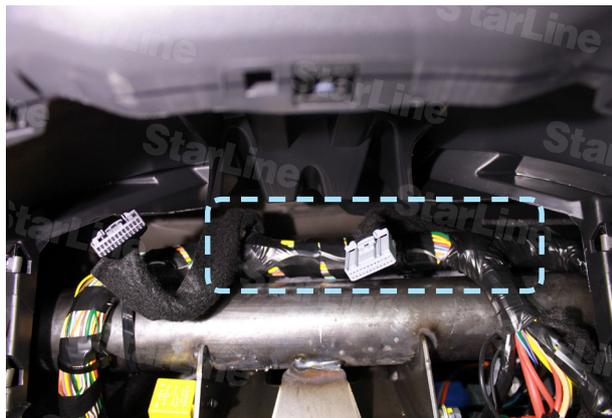
Фото 6. Пример расположения блока StarLine A93 за щитком приборов
