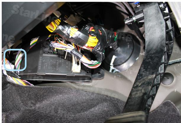
Фото 3.3. Саморез крепления блока ВСМ
