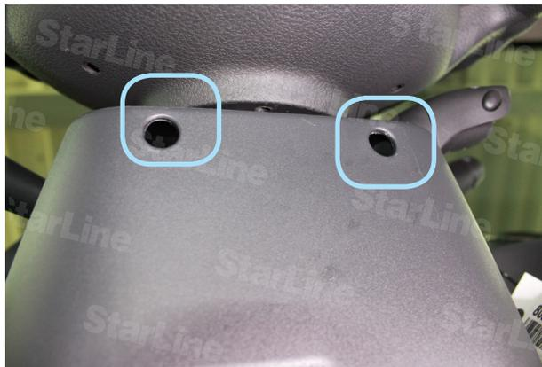
Фото 1.1. Саморезы крепления нижней части рулевого кожуха
