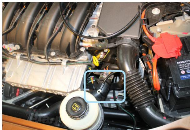
Фото 5.2. Возможное место установки датчика температуры двигателя
