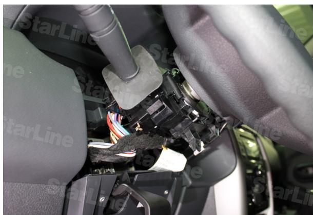
Фото 1.3. Рулевой кожух снят
