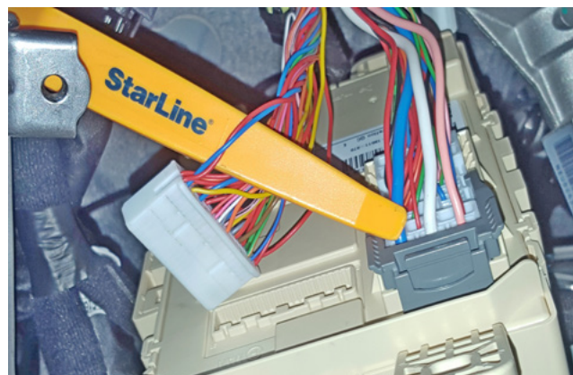
Фото 3.3. Шина CAN-A (синий и красный)
