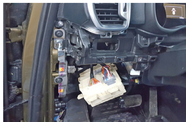
Фото 1.12. Монтажный блок предохранителей снят
