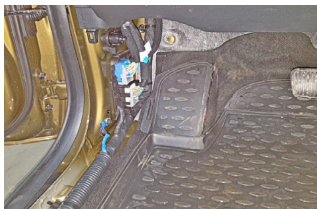
Фото 1.4. Накладка левой кик-панели снята
