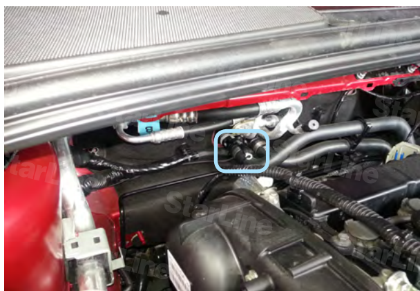
Фото 4.3. Место установки датчика температуры двигателя
