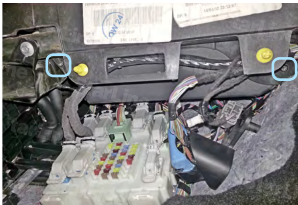
Фото 1.9. Саморезы крепления перчаточного ящика
