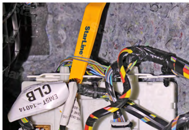
Фото 13.2. Имитация нажатия педали сцепления (сине-оранжевый и зелёно-фиолетовый)
