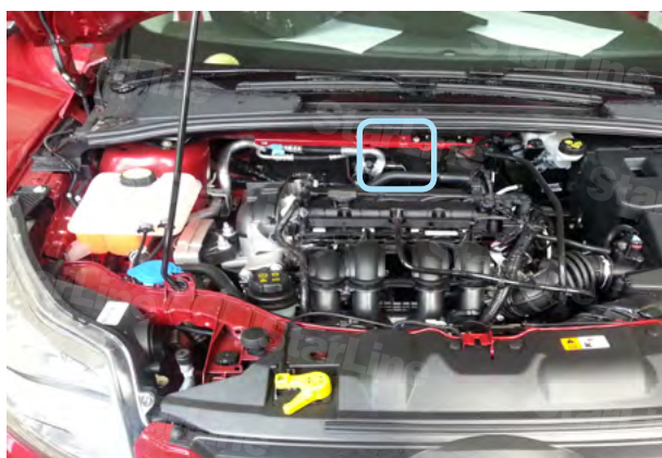
Фото 4.1. Возможное место установки сирены
