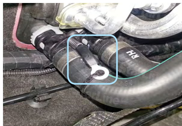
Фото 4.4. Крепление датчика температуры двигателя
