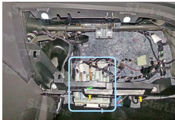
Фото 1.10. Перчаточный ящик снят. Блок ВСМ
