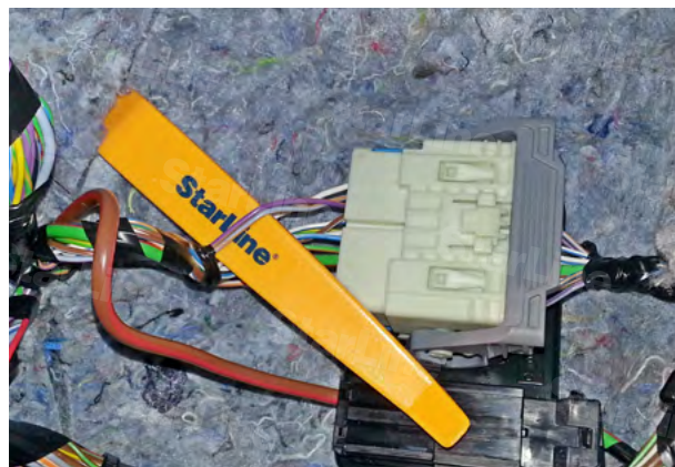
Фото 7.2. Подключение CAN-шины (серо-оранжевый и фиолетово-оранжевый)
