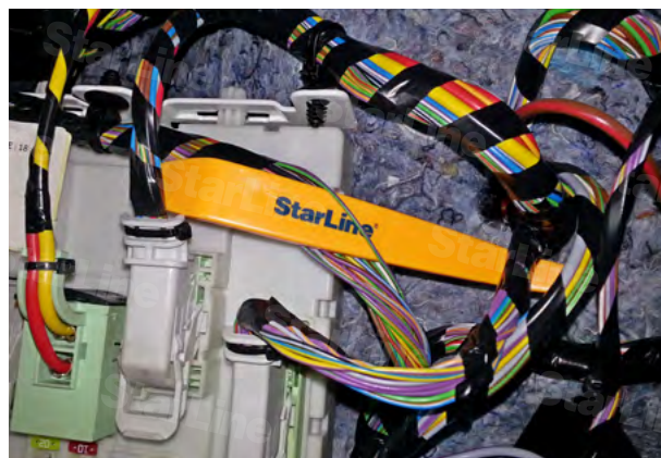
Фото 14.2. Концевик двери водителя (зелёно-фиолетовый)
