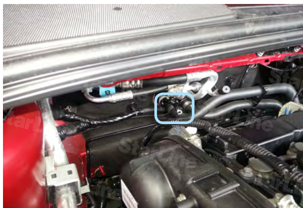
Фото 4.3. Место установки датчика температуры двигателя
