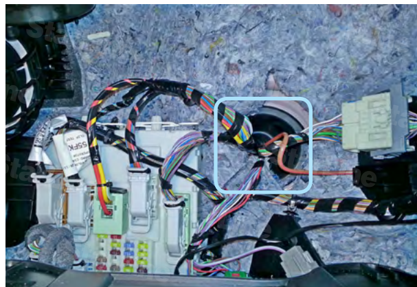
Фото 4.6. Штатный уплотнитель. Вид из салона
