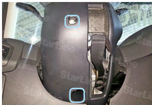
Фото 2.2. Саморез и винт крепления кожуха рулевого вала
