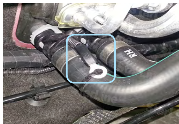
Фото 4.4. Крепление датчика температуры двигателя
