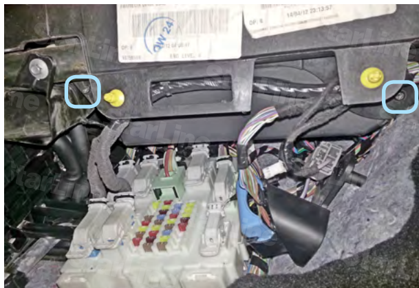
Фото 1.9. Саморезы крепления перчаточного ящика
