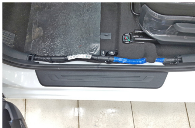
Фото 1.4. Накладка порога двери водителя снята
