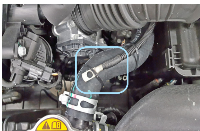
Фото 2.4. Крепление датчика температуры двигателя
