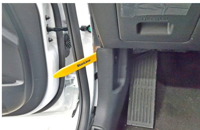
Фото 1.5. Снять накладку левой кик-панели
