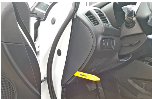
Фото 1.7. Снять боковую накладку передней панели
