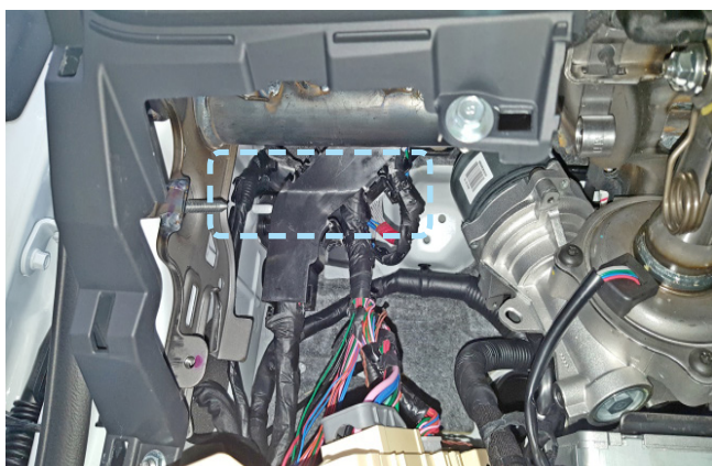
Фото 2.7. Пример расположения центрального блока охранно-телематического комплекса
