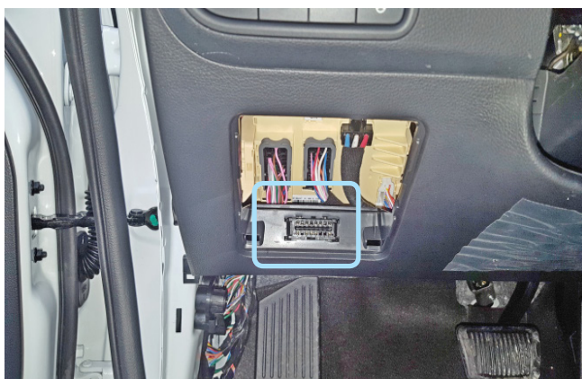
Фото 3.4. Местоположение диагностического разъёма
