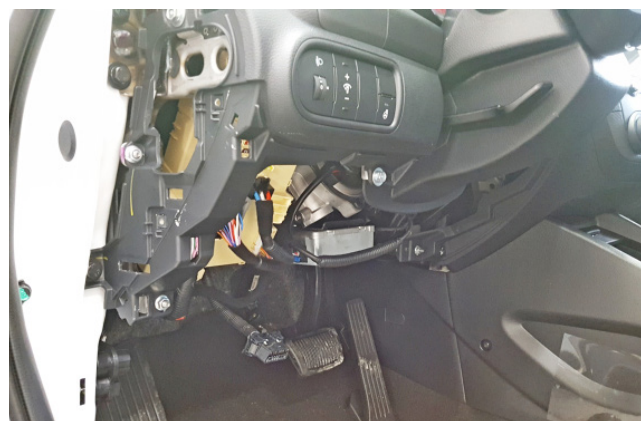
Фото 1.10. Пластиковая накладка под рулевой колонкой снята
