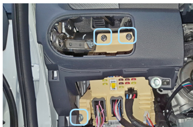
Фото 1.12. Блок кнопок снят. Крепление монтажного блока предохранителей
