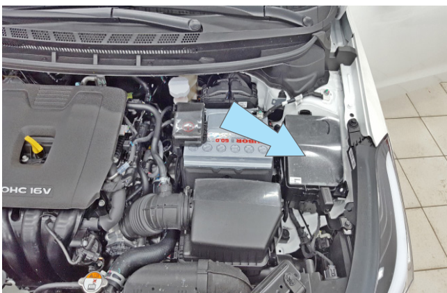
Фото 2.6. Возможное место установки подкапотного блока R6
