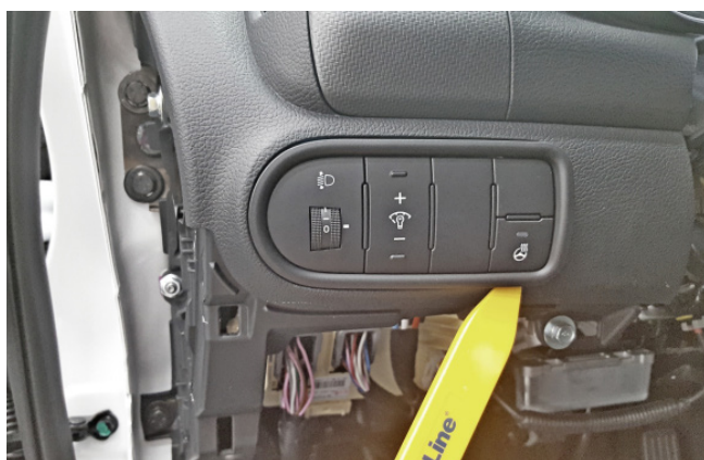
Фото 1.11. Снять блок кнопок слева от рулевой колонки
