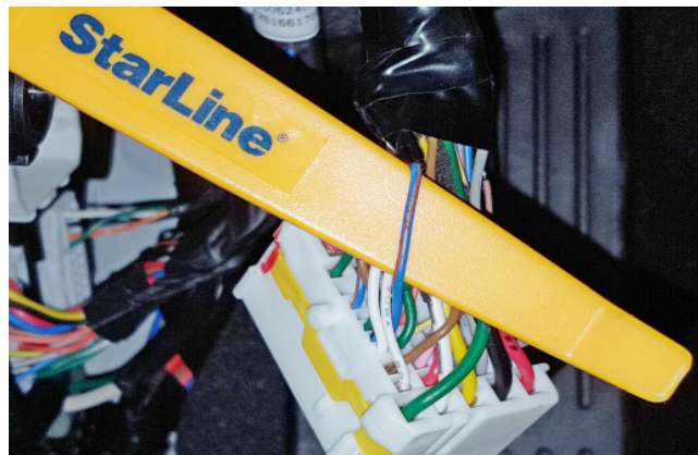
Фото 3.7. Шина данных штатного иммобилайзера (сине-оранжевый)
