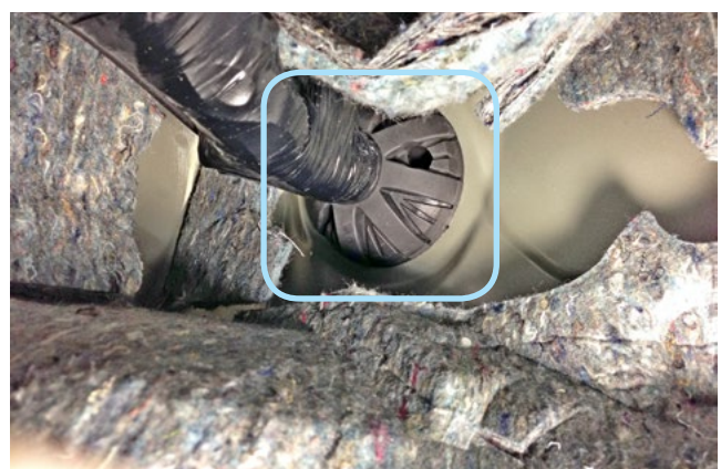
Фото 2.6. Штатный уплотнитель. Вид со стороны салона
