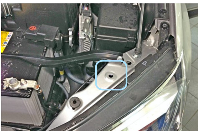
Фото 2.5. Возможное место установки концевика капота
