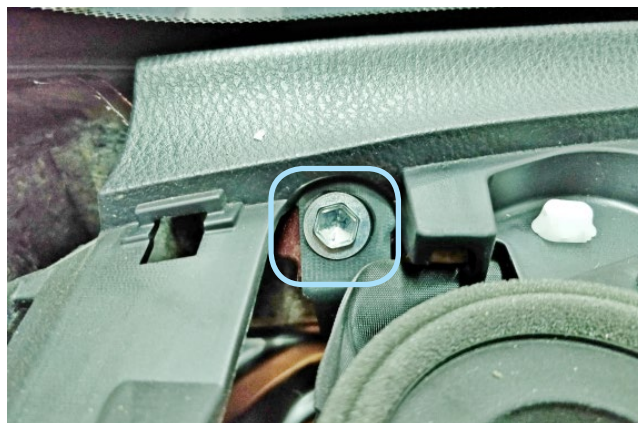
Фото 1.24. Болт крепления слева
