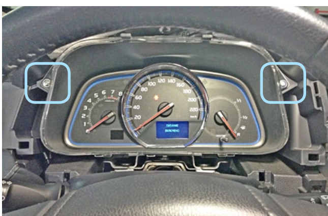
Фото 1.14. Саморезы крепления панели приборов
