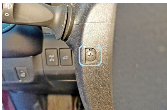
Фото 1.16. Саморез крепления кожуха рулевого вала слева
