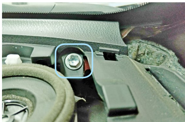
Фото 1.26. Болт крепления справа
