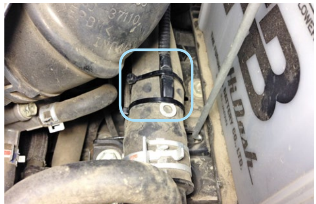
Фото 2.4. Крепление датчика температуры двигателя
