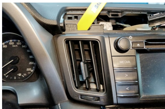
Фото 1.9. Снять воздуховод слева от магнитолы
