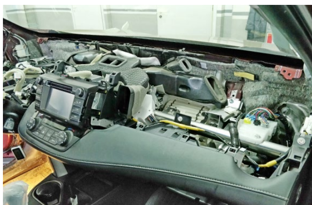
Фото 1.34. Верхняя накладка передней панели снята
