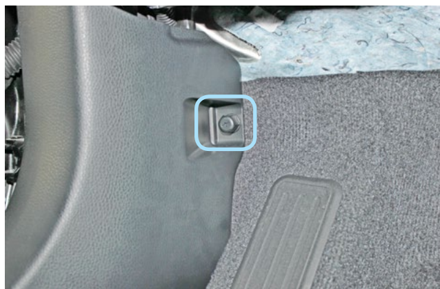
Фото 1.2. Клипса крепления накладки левой кик-панели
