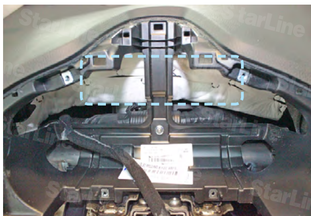
Фото 6. Пример расположения блока StarLine A93 за щитком приборов
