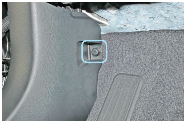
Фото 1.2. Клипса крепления накладки левой кик-панели
