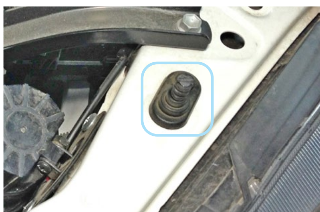
Фото 2.5. Возможное место установки концевика капота
