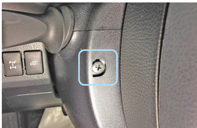
Фото 1.14. Саморез крепления кожуха рулевого вала слева
