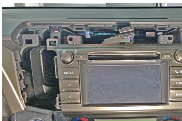
Фото 1.9. Воздуховод слева от магнитолы снят
