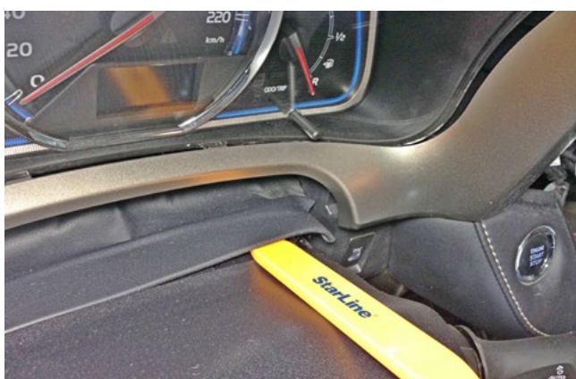
Фото 1.10. Снять пылезащитный кожух
