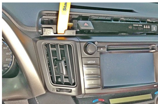
Фото 1.8. Снять воздуховод слева от магнитолы
