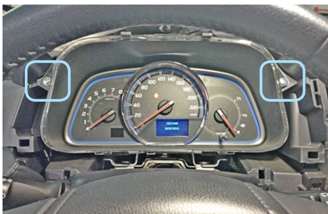
Фото 1.12. Саморезы крепления панели приборов
