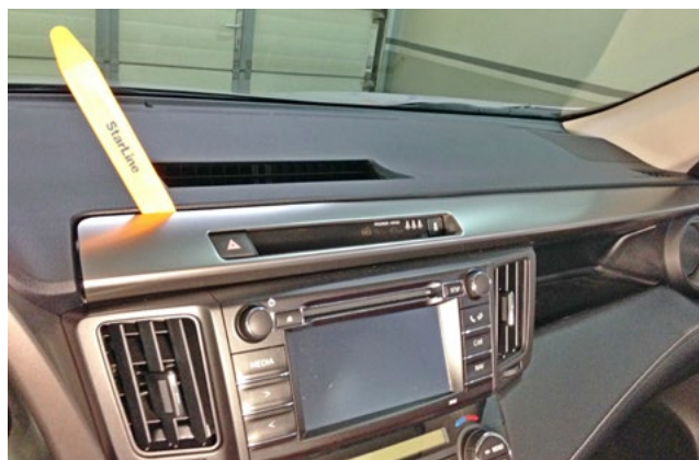
Фото 1.7. Снять верхнюю декоративную накладку
