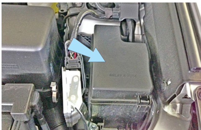
Фото 2.7. Возможное место установки подкапотного блока R6
