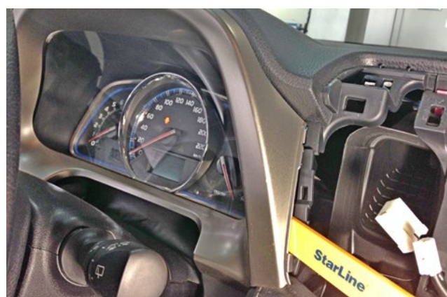
Фото 1.11. Снять декоративную накладку панели приборов
