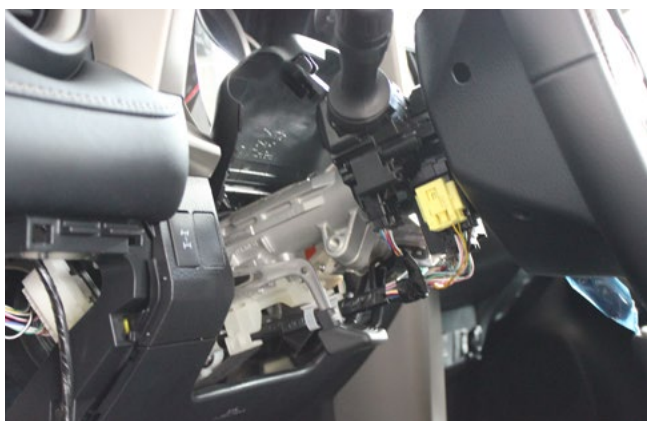
Фото 1.16. Кожух рулевого вала снят
