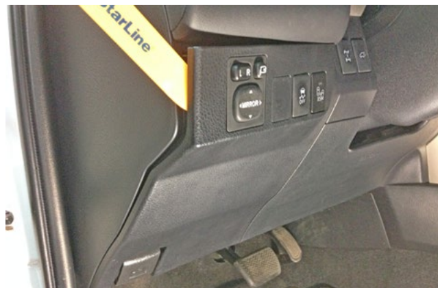
Фото 1.4. Снять декоративную накладку слева от рулевой колонки
