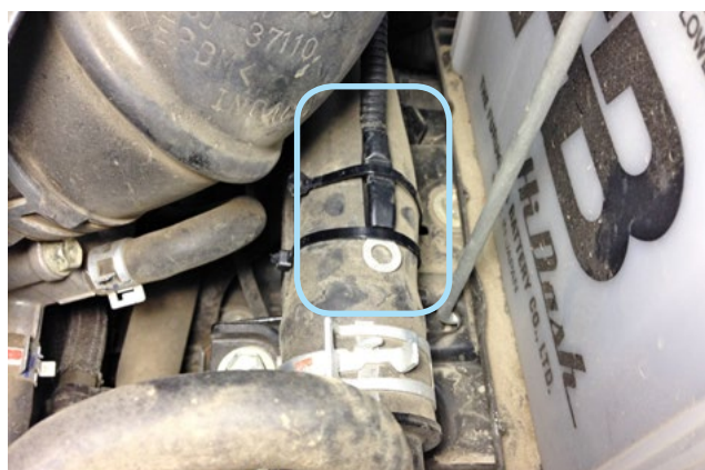
Фото 2.4. Крепление датчика температуры двигателя
