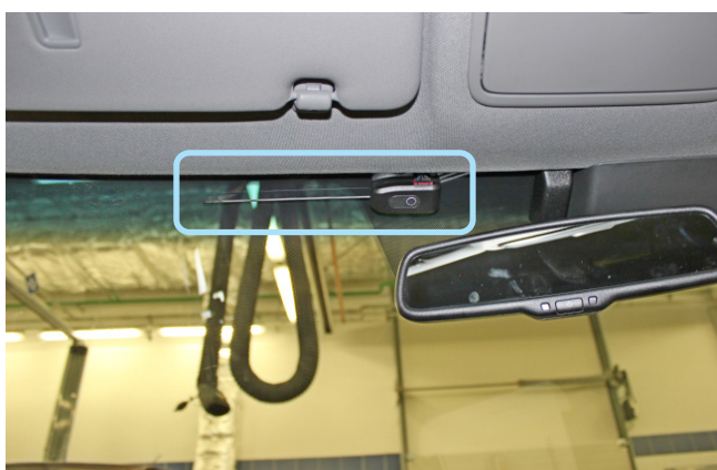
Фото 2.1. Возможное место установки антенного модуля
