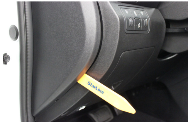
Фото 1.2. Снять левую боковую накладку передней панели
