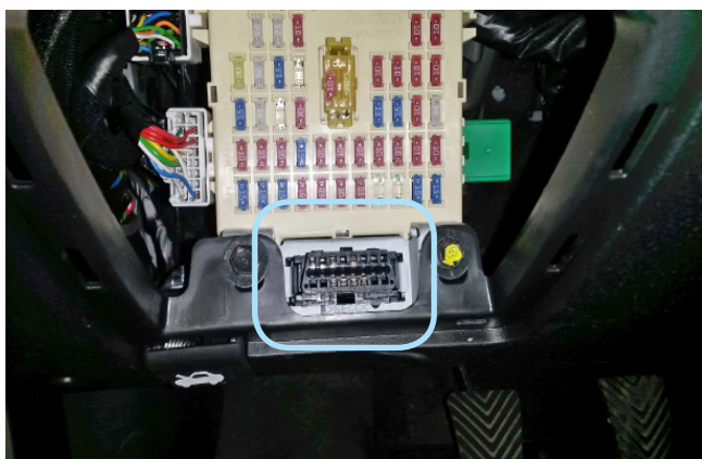
Фото 3.2. Местоположение диагностического разъёма
