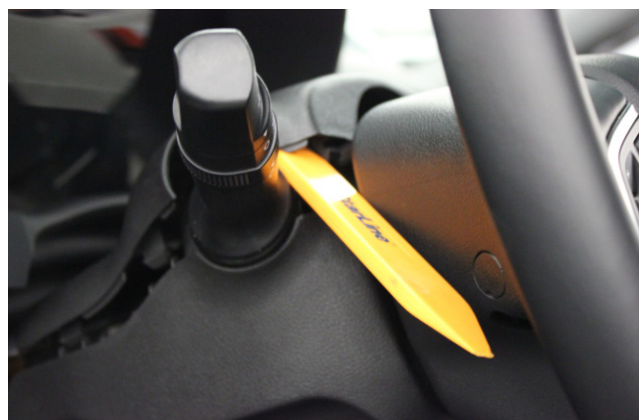
Фото 1.8. Снять верхнюю часть кожуха рулевого вала
