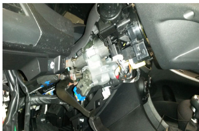
Фото 1.12. Кожух рулевого вала снят
