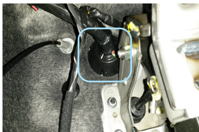
Фото 2.8. Штатный уплотнитель. Вид со стороны салона
