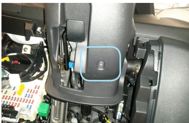
Фото 1.11. Саморез крепления нижней части кожуха рулевого вала снизу
