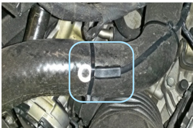
Фото 2.6. Крепление датчика температуры двигателя
