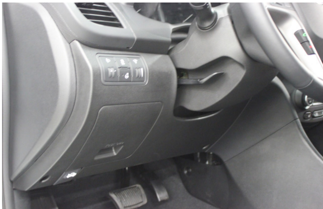
Фото 1.1. Пластиковая накладка под рулевой колонкой. Общий вид
