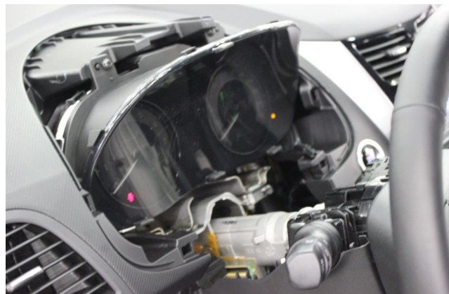
Фото 1.14. Накладка панели приборов снята
