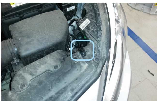
Фото 2.7. Возможное место установки концевика капота
