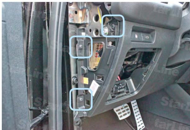
Фото 1.7. Боковая накладка передней панели снята. Саморезы
