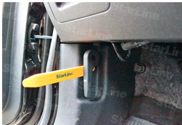
Фото 1.4. Снять ручку отпирания капота
