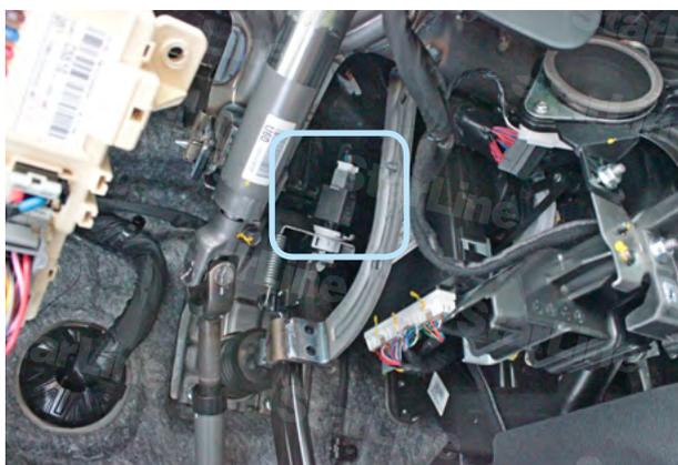
Фото 8.3. Местоположение разъёма концевика педали тормоза
