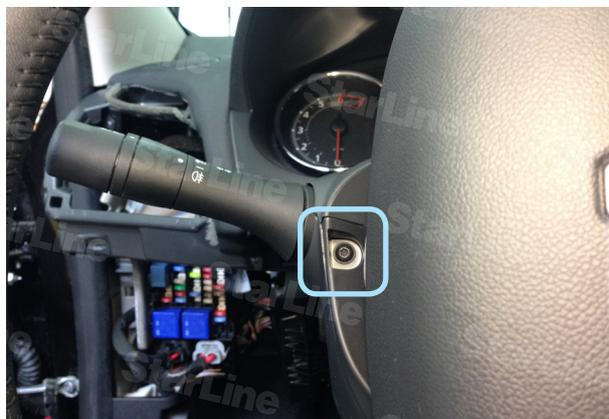
Фото 2.2. Саморез крепления верхней части кожуха
