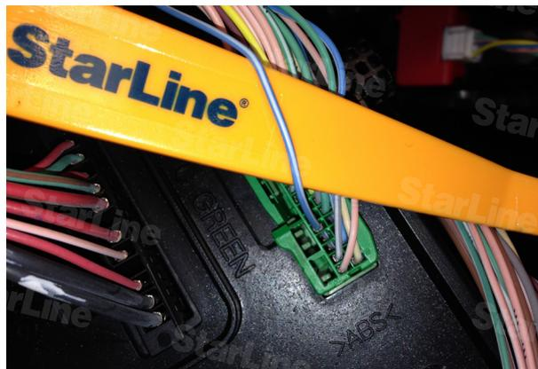
Фото 10.2. Концевик двери водителя (сине-белый, pin 16)
