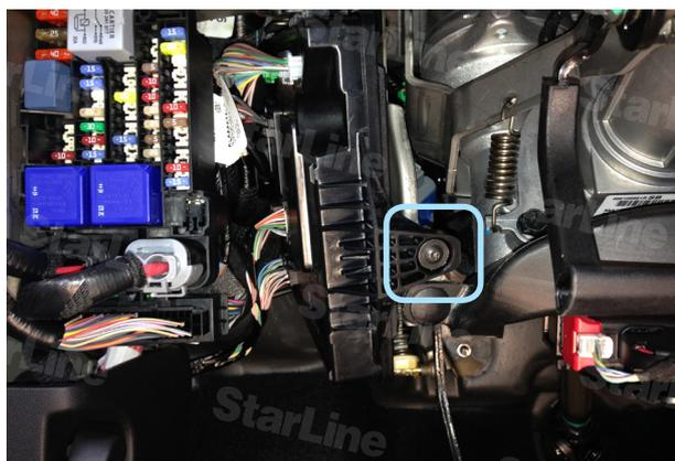
Фото 3.1. Винт крепления блока VCM
