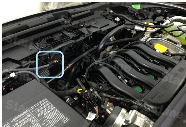
Фото 5.4. Местоположение разъёма штатного концевика капота
