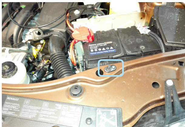
Фото 5.3. Возможное место установки концевика капота. Отрезать два деления
