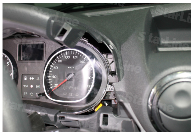
Фото 2.8. Декоративная накладка справа от щитка приборов снята
