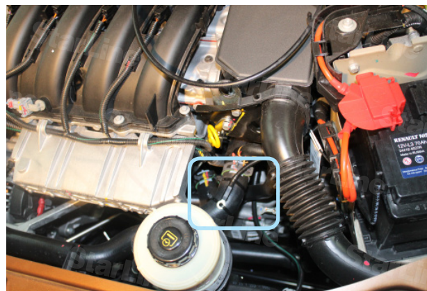
Фото 5.2. Возможное место установки датчика температуры двигателя
