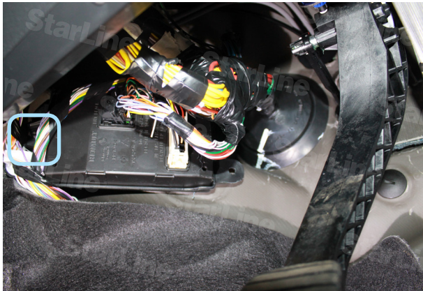
Фото 3.3. Саморез крепления блока ВСМ
