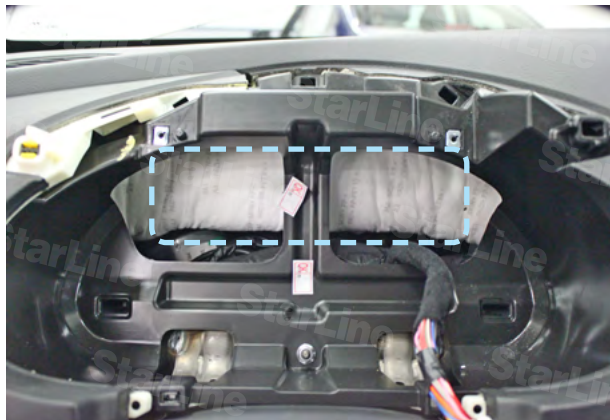
Фото 5. Пример расположения центрального блока охранно-телематического комплекса
