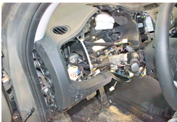
Фото 3.5. Щиток приборов снят
