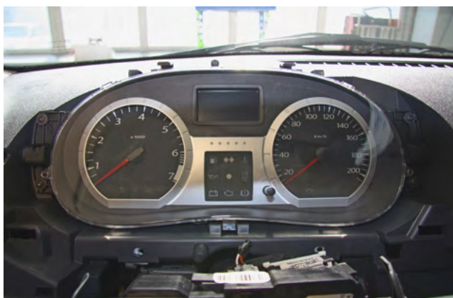
Фото 1.12. Декоративная накладка панели приборов снята
