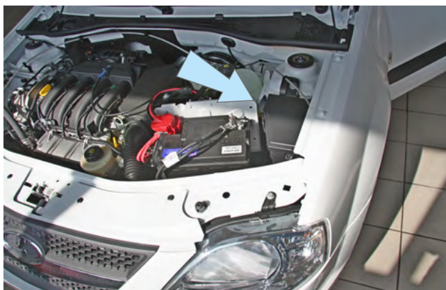
Фото 2.7. Возможное место установки подкапотного блока R6
