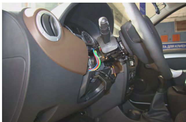
Фото 1.4. Кожух рулевого вала снят
