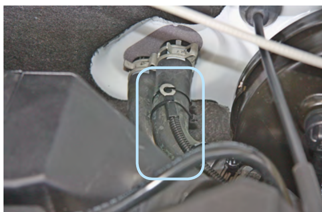
Фото 2.4. Крепление датчика температуры двигателя
