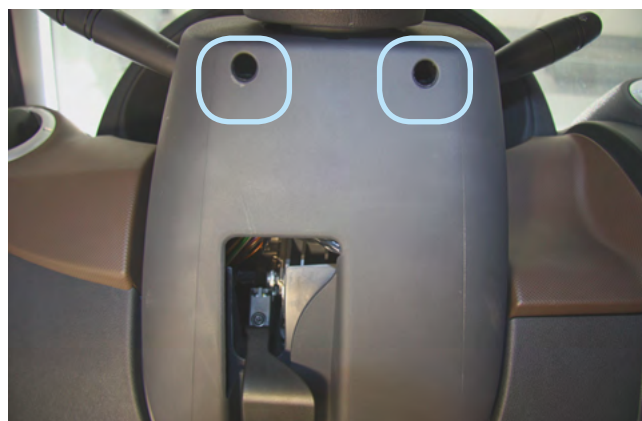
Фото 1.2. Саморезы крепления нижней части
