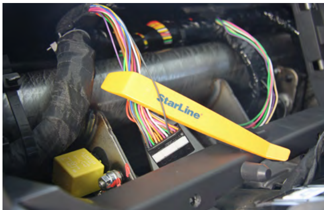
Фото 3.2. Контроль концевика стояночного тормоза (серый)
