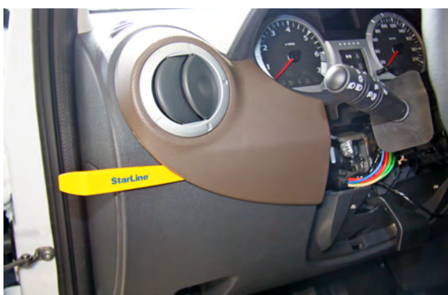
Фото 1.9. Снять декоративную накладку слева от панели приборов
