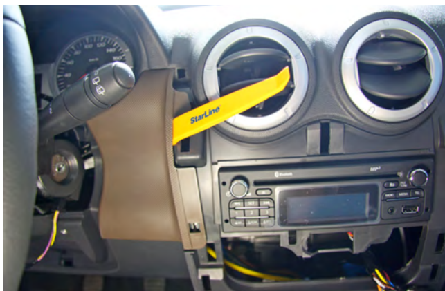
Фото 1.7. Снять декоративную накладку справа от панели приборов
