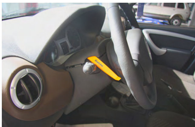
Фото 1.3. Снять верхнюю часть кожуха
