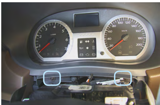
Фото 1.11. Саморезы крепления декоративной накладки панели приборов
