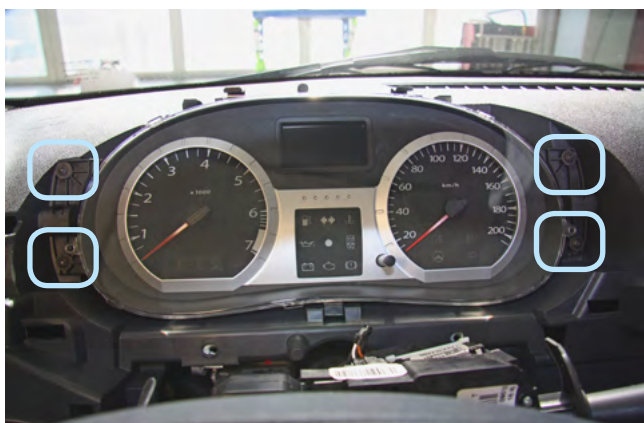
Фото 1.13. Саморезы крепления панели приборов
