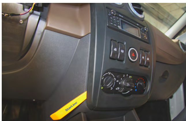
Фото 1.5. Снять декоративную накладку центральной консоли
