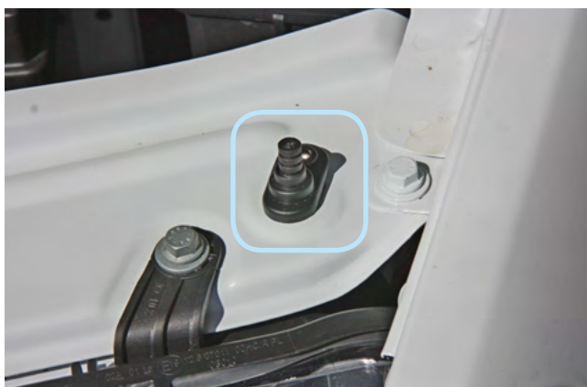
Фото 2.5. Возможное место установки концевика капота
