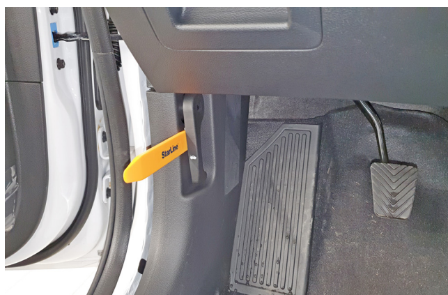
Фото 1.4. Снять ручку отпирания капота
