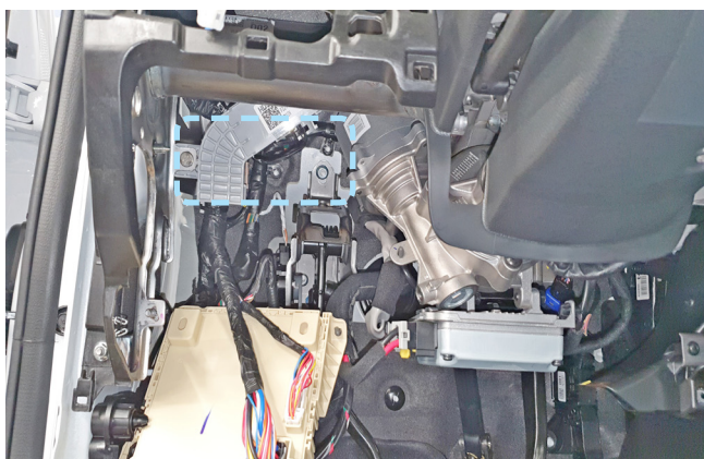
Фото 2.7. Пример расположения центрального блока охранно-телематического комплекса
