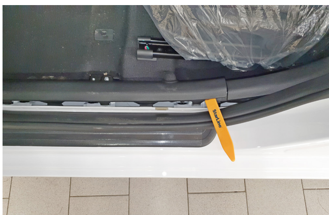
Фото 1.3. Снять накладку порога двери водителя
