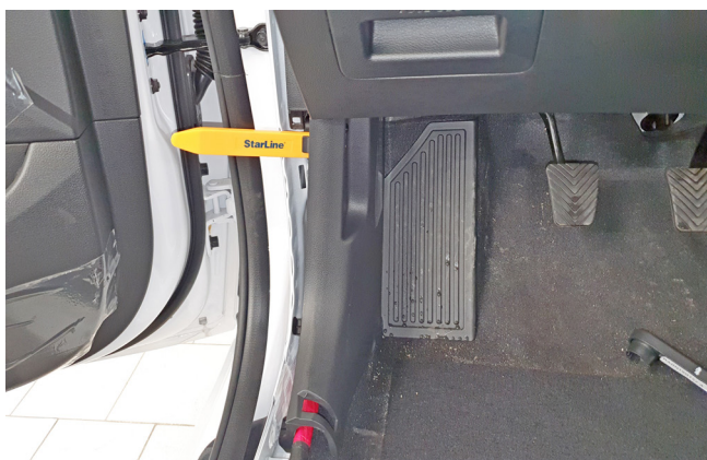
Фото 1.5. Снять накладку левой кик-панели
