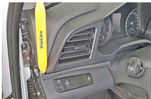
Фото 1.12. Снять декоративную накладку
