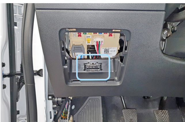
Фото 3.4. Местоположение диагностического разъёма
