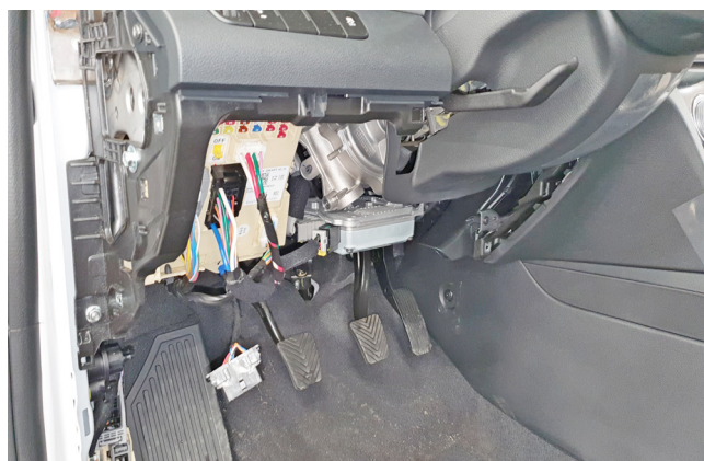
Фото 1.10. Пластиковая накладка под рулевой колонкой снята
