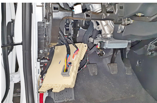
Фото 1.15. Монтажный блок предохранителей снят
