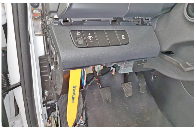
Фото 1.13. Снять блок кнопок
