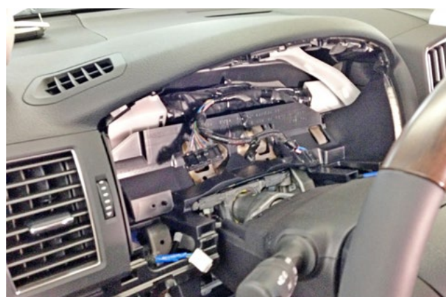
Фото 1.22. Панель приборов снята
