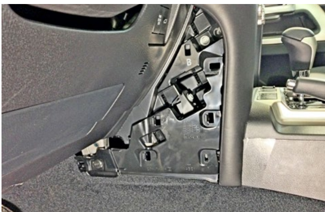
Фото 1.3. Левая боковая накладка центральной консоли снята
