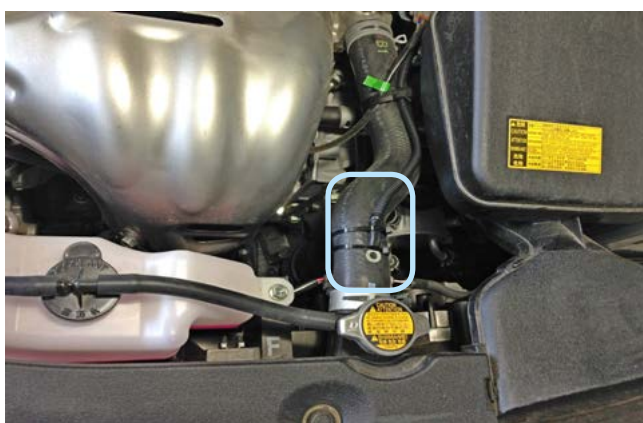
Фото 2.5. Место установки датчика температуры двигателя
