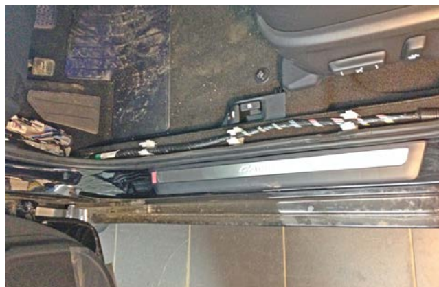
Фото 1.4. Накладки порога и левой кик-панели сняты
