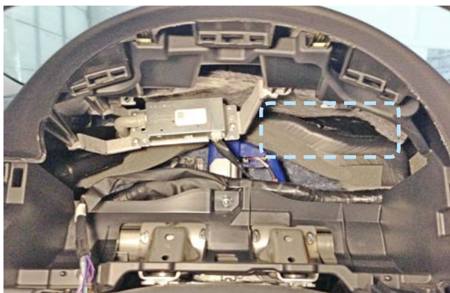
Фото 2.8. Пример расположения центрального блока охранно-телематического комплекса
